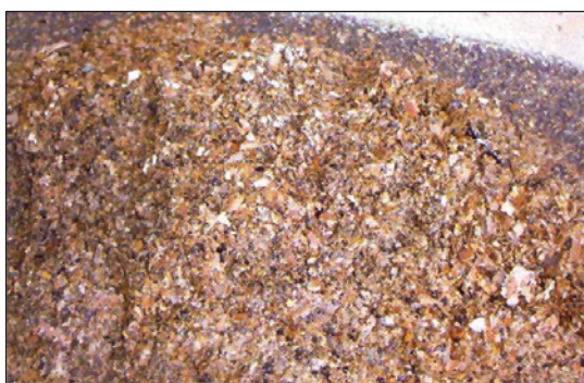
شکل ۷: رسوب سیلیکات خارج شده از بدنه سوم، کارخانه راین
