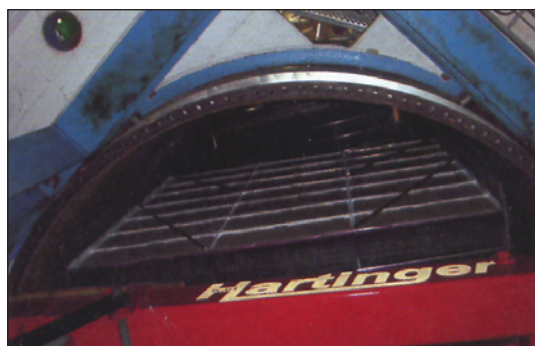
شکل ۱۳: وارد کردن بسته‌صفحه‌ای دومی در مخزن به‌وسیله جک هیدرولیکی
