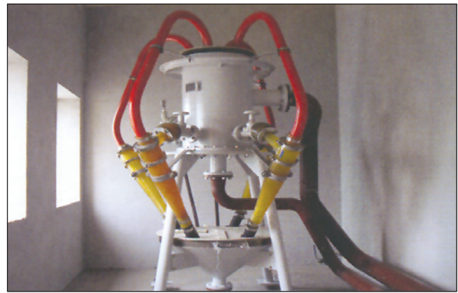
شکل ۱۵: هیدروسیکلون به منظور جداسازی مواد جامد از فراکسیون مواد سفیده‌ای
